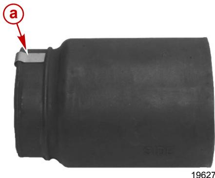
Masseclip am Abgasrohr abgebildet, Masseclips am Gelenkwellen-Gummibalg ähnlich
